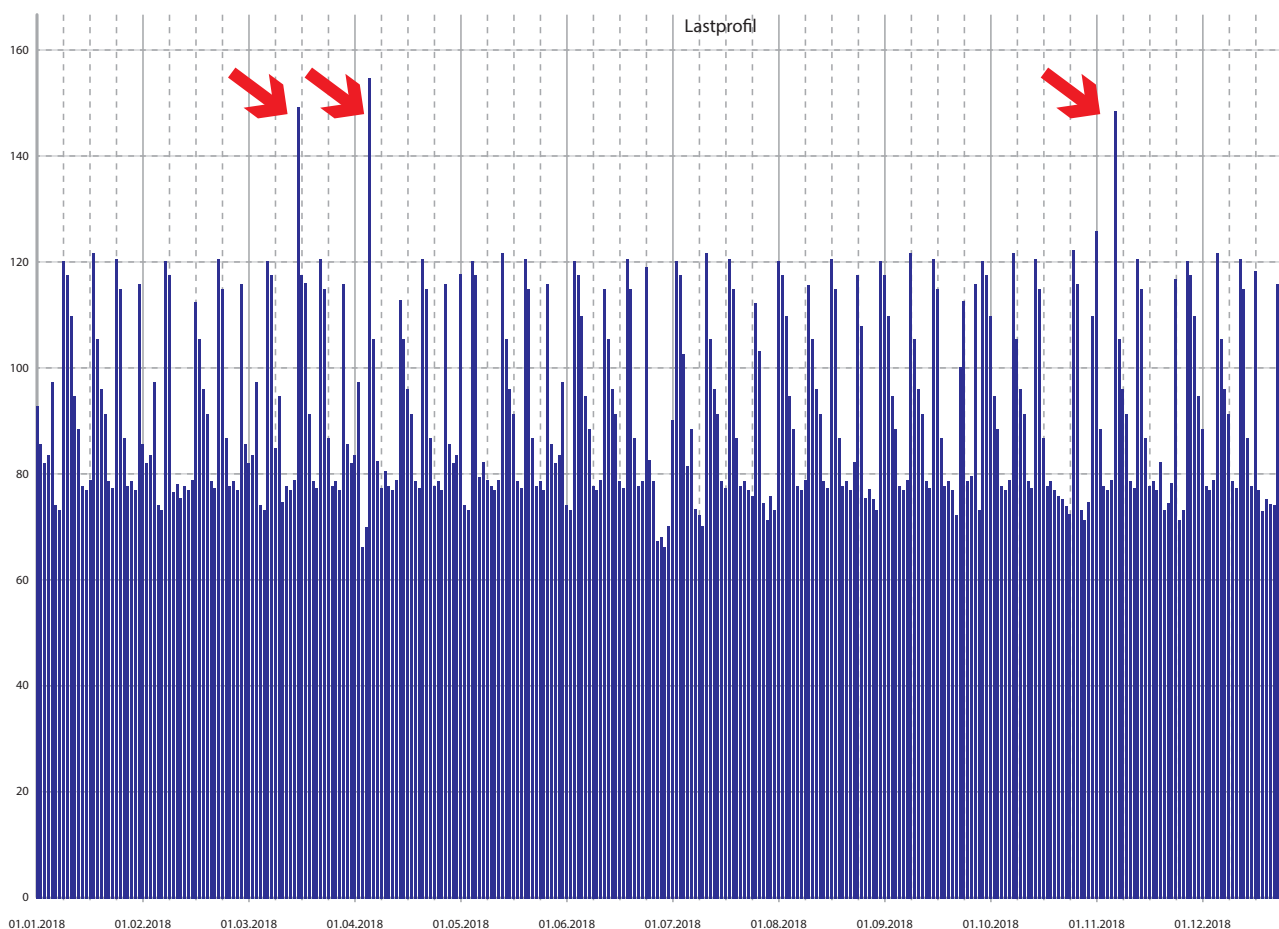
Anzeige der Rohwerte als Lastprofil mit ausgeprägten Leistungsspitzen
