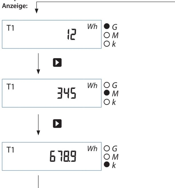
Anzeige der Wirkarbeit  $W_{\text{Wirk}}$  in kWh, MWh bzw. GWh und der Blindarbeit  $W_{\text{Blind}}$  in kvarh, Mvarh bzw. Gvarh. Der ausgegebene Messwert muss mit der entsprechenden Anzeigewertigkeit "Kilo", "Mega" oder "Giga", je nach leuchtender LED, bewertet werden.
