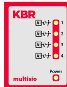
Power-LED an: Betriebsspannung liegt an
