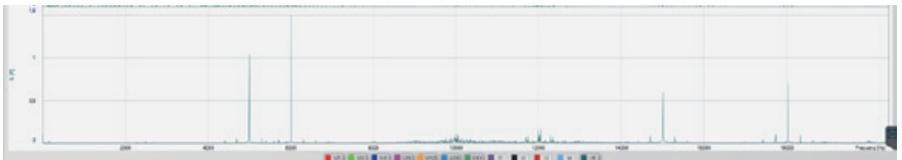
Frequenzspektrum einer Anlage mit Umrichtern mit hohen Ableitströmen in höheren Frequenzbereichen
