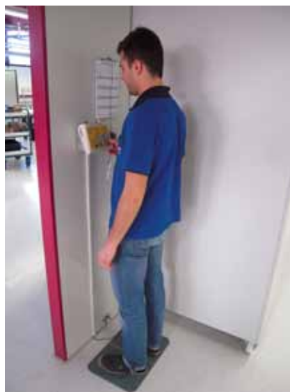
Der Grounding Tester prüft die Funktion der Schutzkleidung.
